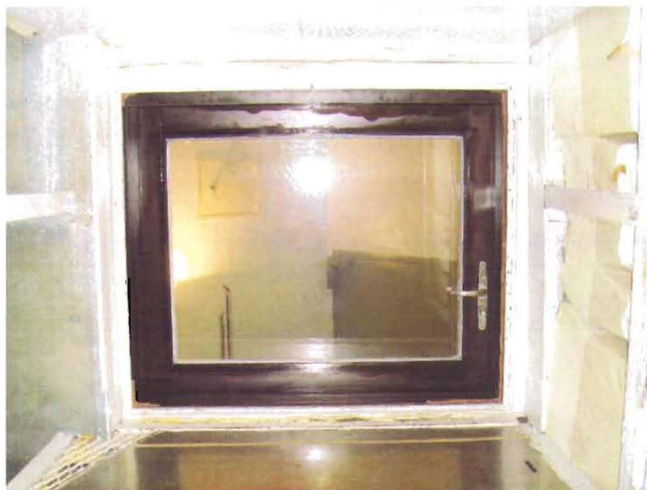
圖 1 試樣佈置圖 (無響室)
